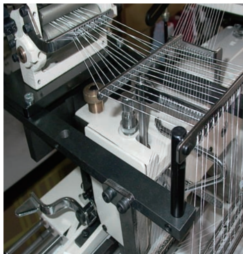
針糸用送り装置 Metering device for needle thread Dispositivo de elastico para el hilo de la aguja 装饰线用送线装置
