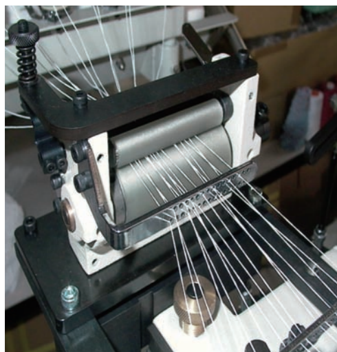
飾り糸用送り装置 Metering device for smocking thread Dispositivo de elastico para el hilo del smocking 针线送线装置
